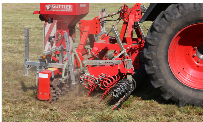
Zinken senkrecht stellen und belasten durch Anheben der Walze.
