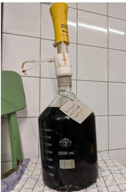
Bild 20: Gewindeflasche 5000ml mit aufgeschraubtem Dispenser für die Abfüllung.
