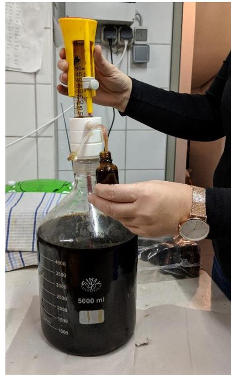
*Bild 22: Durch Absenken wird das Fläschchen exakt mit der eingestellten Menge an Propolislösung gefüllt.*
