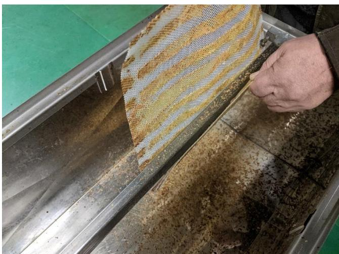
*Bild 6: Mit Zug nach oben wird das Propolisgitter über die Schiene gezogen. Das spröde Propolis splittert ab und fällt in die Wanne.*
