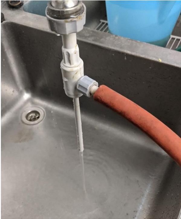
*Bild 16: Wasserstrahlpumpe am Wasserhahn. Mit Gummischlauch in Vakuumausführung.*
