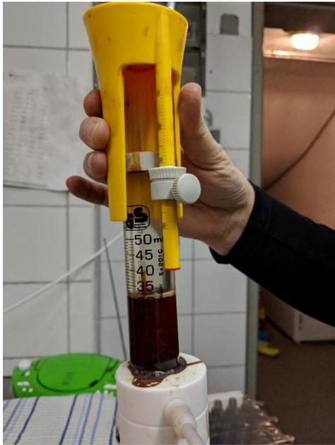
*Bild 21: Dispenser für 10 bis 50 ml Füllmenge. Mit der weißen Schraube wird die Füllmenge eingestellt. Durch Anheben wird gefüllt.*
