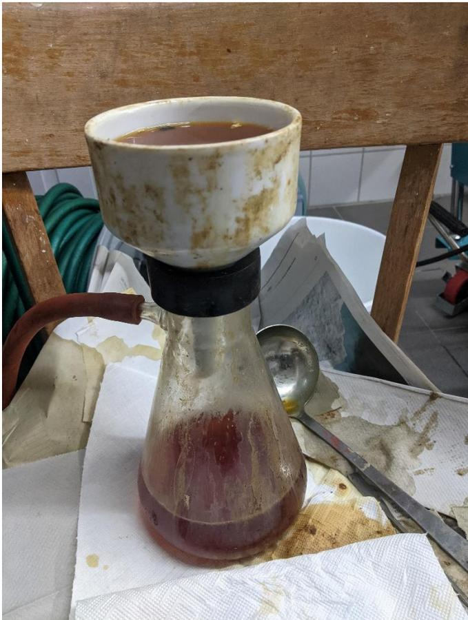
*Bild 17: Saugflasche mit Manschette und Büchner-Trichter. Mit Propolisansatz gefüllt.*
