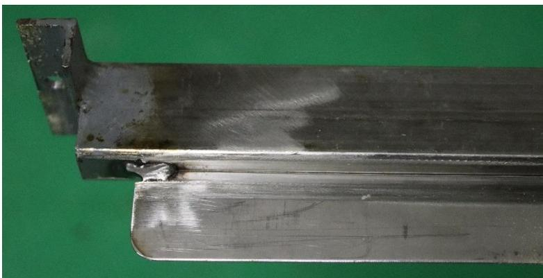
*Bild 3: An der Unterseite der Einlegestange wird ein 4 cm breite Schiene angeschweißt.*
